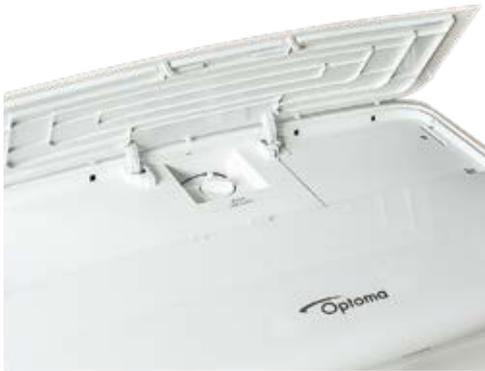
Die Bedienelemente für die Verstellung von Zoom und Shift sind hinter einer großen Klappe auf der Oberseite des Beamers versteckt. Auch das Lampenmodul ist über diese Klappe zugänglich, wenn es einmal getauscht werden muss.
