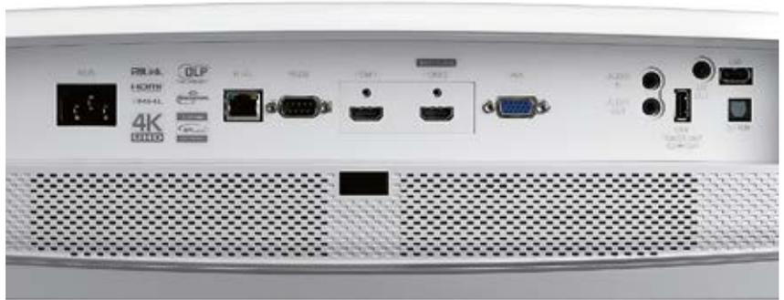
Hinten, etwas versenkt, befindet sich das Anschlussfeld. Für digitale Bildsignale sind zwei HDMI-Buchsen vorhanden, aber nur eine unterstützt HDMI 2.0 für die Wiedergabe von UHD mit 60 Hz. Sie ist auch MHL-fähig für die Zuspiegelung von Mobilgeräten. Aber auch analoge Signale finden über eine VGA-Buchse noch Anschluss. Komplettiert werden die Schnittstellen durch USB, Audio-Ein- und Ausgänge sowie eine RS232- sowie LAN-Buchse.
