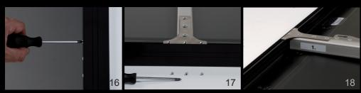
Центральные стойки монтируются на уже установленных креплениях. Выкрутите винты и установите центральную опору как показано на картинках. Закрепите центральную опору тремя крестообразными скрытыми винтами.
