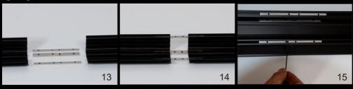
В случае разделенных профилей их соединяют линейными креплениями. Задвиньте каждое крепление на половину его длины в два соединяемых рамных элемента. Соедините профили таким образом, чтобы не было никакого зазора и закрепите их винтами с шестигранной головкой с помощью прилагаемого ключа.
