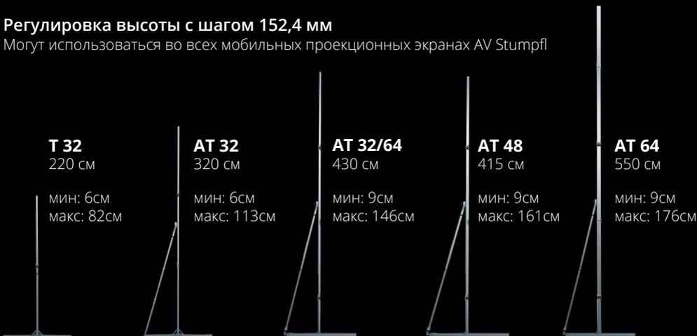
Когда требуется высокая степень устойчивости, особенно с большими экранами или большой высотой установки, рекомендуется использовать следующие опорные стойки: AT 32 для MONOBLOX 32 и AT48 или AT64 для MONOBLOX 64. Опорные стойки AT имеют задние телескопические опоры, закрепляемые двумя винтами с барашком.
