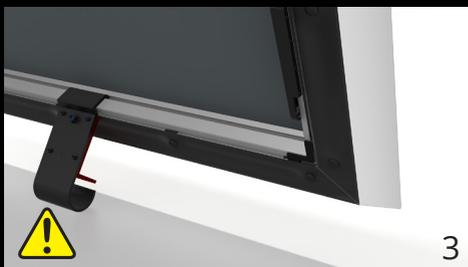
Опору для поднятия экрана разместить во внутреннем желобе **1** и повернуть наружу. Данное действие отпустит блокировку и угловая скобка войдет в нижний желоб, а также зафиксирует опору для поднятия экрана **2**. Когда полотно закреплено на раме FullWhite® опоры для поднятия экрана будут держать проекционный экран над полом и защищать полотно от повреждений **3**.
