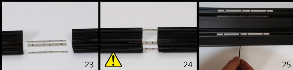
В случае разделенных профилей их соединяют линейными креплениями. Задвиньте каждое крепление на половину его длины в два соединяемых рамных элемента. Соедините профили таким образом, чтобы не было никакого зазора и закрепите их винтами с шестигранной головкой с помощью прилагаемого ключа
