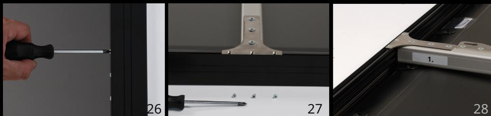
Центральные стойки монтируются на уже установленных креплениях. Выкрутите винты и установите центральную опору как показано на картинках. Закрепите центральную опору тремя крестообразными скрытыми винтами.
