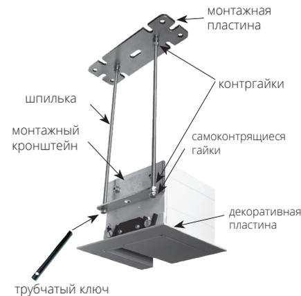
Все проекционные экраны Inline встраиваются в потолок. Декоративные пластины с двух сторон экрана защелкиваются отдельно от защитного короба для обеспечения быстрого доступа к монтажным винтам при обслуживании.
