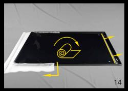
Heben Sie die ALR Projektionsfolie zu keinem Zeitpunkt, da dies zur Beschädigung führen kann.
