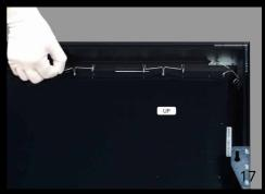
Verwenden Sie die restlichen Federhaken, um die Folie am Rahmen zu befestigen.
