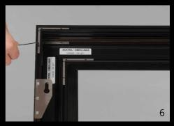
Schieben Sie die Rahmenelemente spaltfrei zusammen und fixieren Sie diese mit dem mitgelieferten Sechskantschlüssel an den Gewindestiften.
