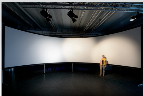
Экран CURVE на стандартных опорных стойках. Размер экрана: ширина 11м, высота 2,6м, радиус 4,2м
