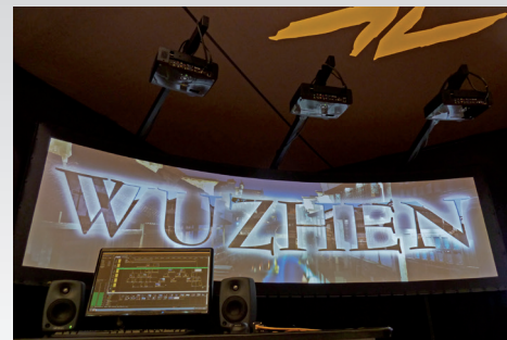
Экран CURVE в комбинации с экраном Desertscreen (3 кронштейна для проекторов). Размер экрана: ширина 6м, высота 1,8м, радиус 6,8м
