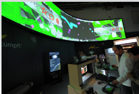
Панорамная мультипроекция на экран CURVE, площадь изображения 3.5м. Размер экрана: ширина 14,2м, высота 3,2м, радиус 7м
