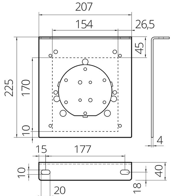
DIE BEFESTIGUNGSWINKEL DER PROJEKTIONSWAND SIND MIT DER DECKENKONSTRUKTION KRAFT- UND FORMSCHLÜSSIG ZU VERBINDEN ! DAS ALUMINIUMGEHÄUSE DARF MECHANISCH NICHT ZUSÄTZLICH BELASTET WERDEN ! DIE AUFHÄNGUNG MUSS SICHERSTELLEN, DASS KEIN VERWINDEN AUFTRETEN KANN !
